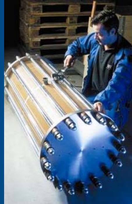
Alkalisches Elektrolysemodul 25 bar Drucktechnologie
